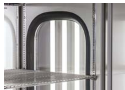
Beaucoup de lumière, mais pas trop de chaleur: Ces tubes fluorescents sont isolés thermiquement de la chambre d'essais
