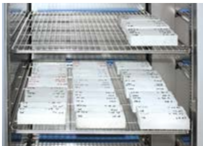
Des essais de variation gel-dégel pour des essais de matériaux de construction démontrent la résistance du matériel.
